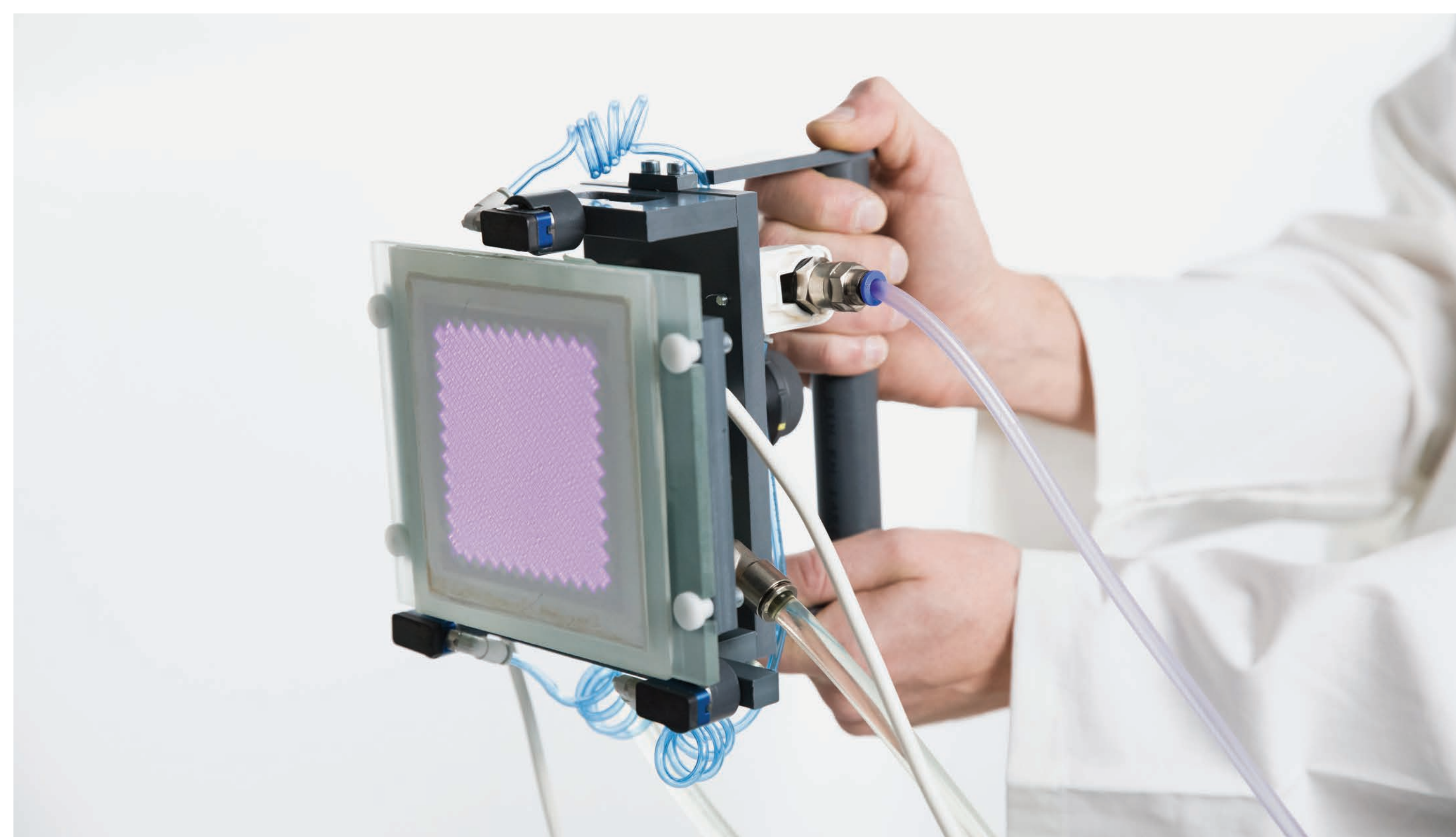
Vyvíjené plazmové zařízení v rámci mezinárodní spolupráce s podniky pro precizní ošetření povrchu skla.
