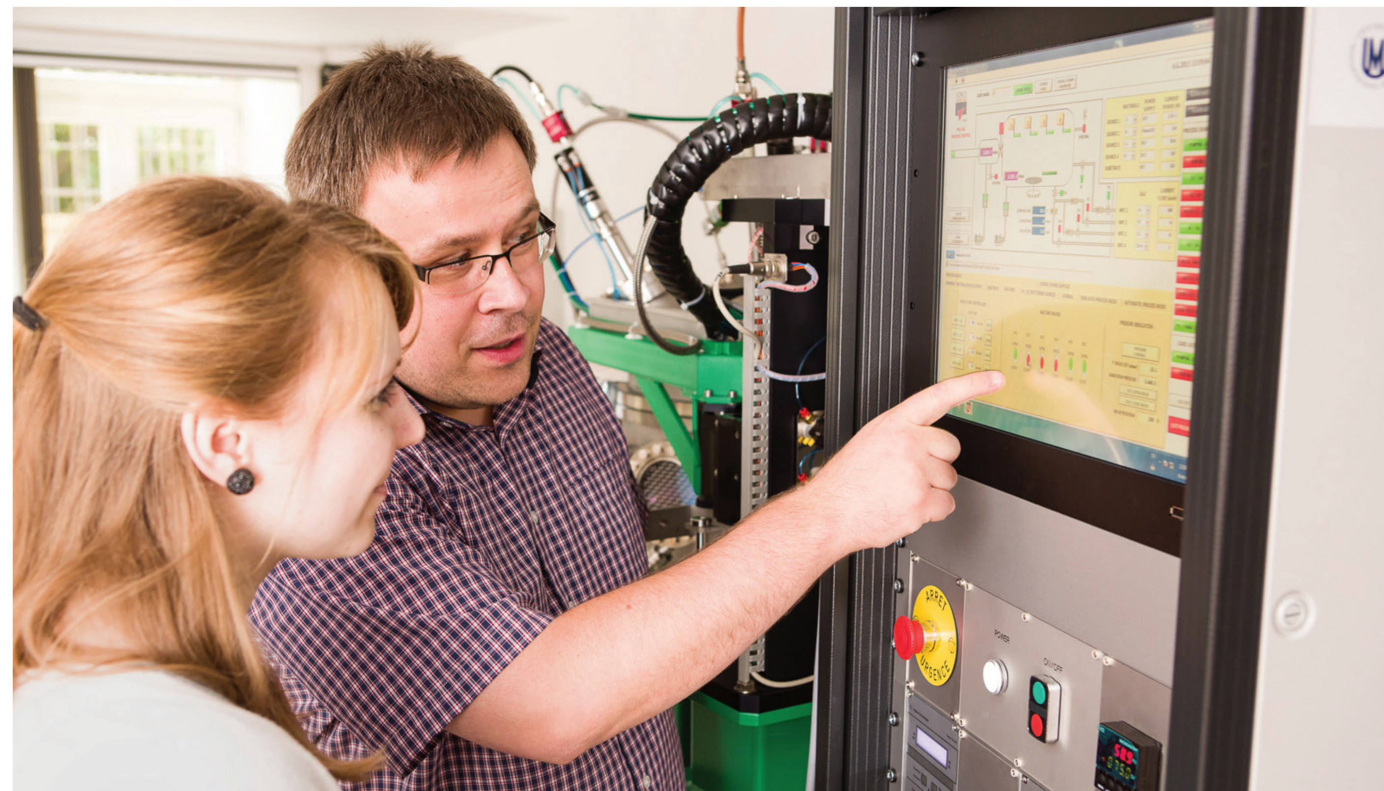
Programování počítačem řízeného depozičního procesu pro růst nanokompozitní tenké vrstvy.
