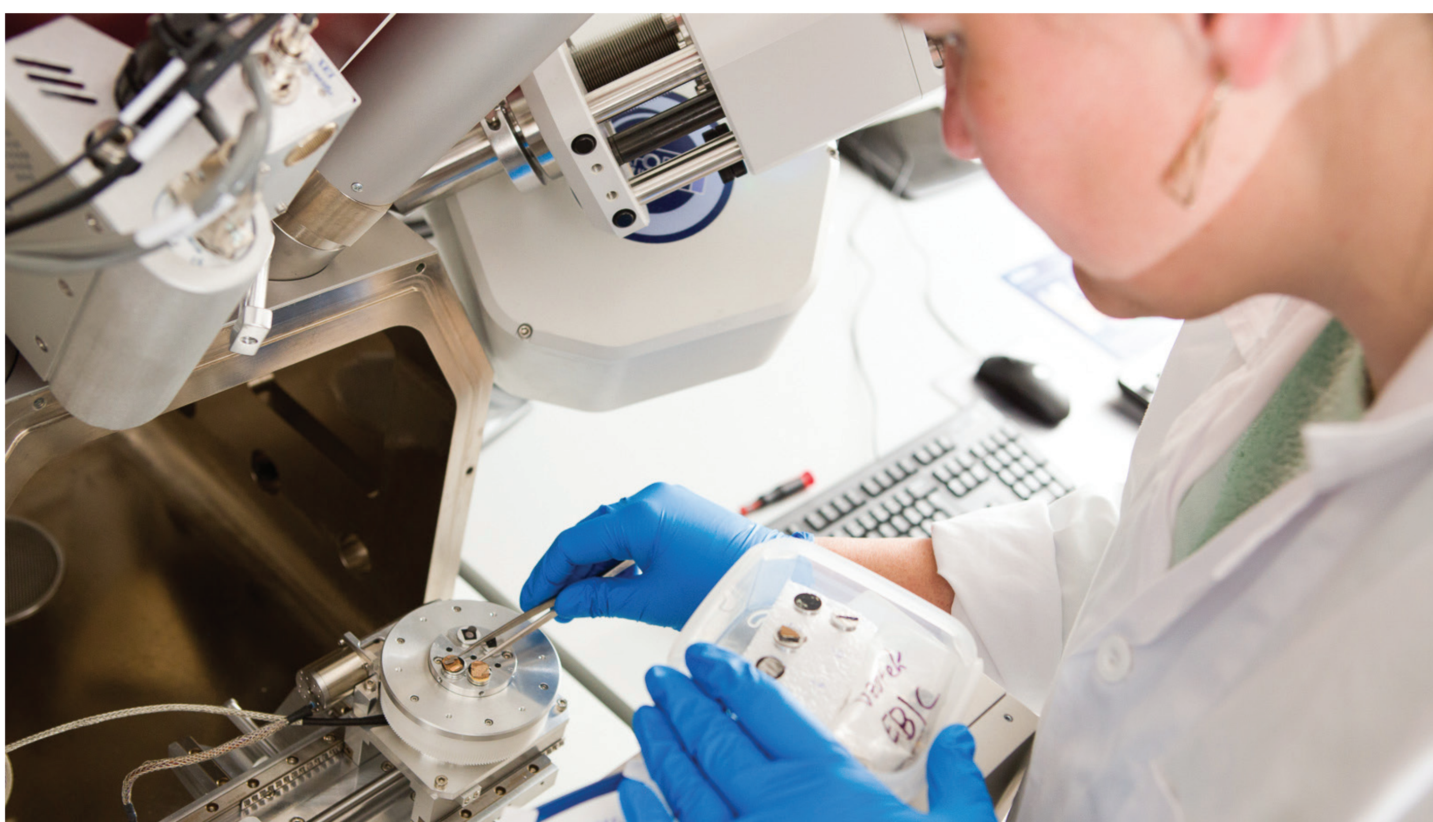
Diagnostika povrchu materiálů pomocí skenovacího elektronového mikroskopu umožňující rozlišení až jednotky nanometrů.
